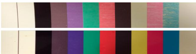
**Image 1:** Impression de façon numérique exposée à l'extérieur sans protection d'un pelliculage (en haut) et avec la protection d'un pelliculage (en bas).
