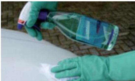
5. Reinigen Sie die Oberfläche mit Avery Dennison Surface Cleaner bevor Sie mit einem neuen Verklebevorgang beginnen.
